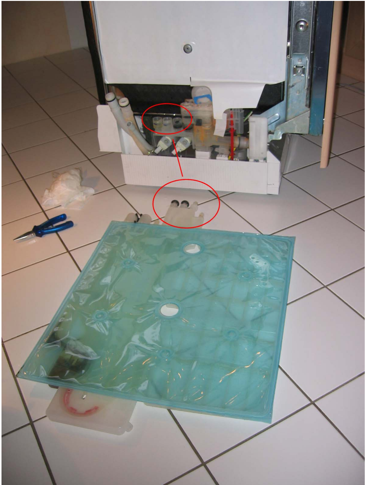
Abbildung 5 : Abmontierte Wassertasche
