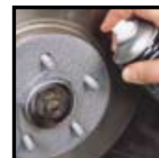
Loctite® 8150 банка Loctite® 8151 аэрозоль, Loctite® 8060 тубик Противозадирная смазка с содержанием алюминия для болтов, гаек, труб, теплообменников и т.п. Типичные применения: крепление колеса на ступицу.
